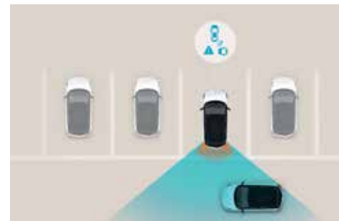
Aktivni sistem za preprečevanje naleta s strani pri vožnji vzvratno (RCCA).
