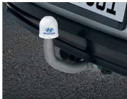
Vlečna kljuka – vertikalno snemljiva (HEV, PHEV) G2281ADE00 za vozila z vpisano vertikalno obremenitvijo 40 kg v homologaciji
