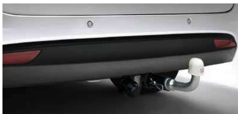
Vlečna kljuka domačega proizvajalca / horizontalno snemljiva / ko ni v uporabi, je vidna Več informacij pri pooblaščenem prodajalcu vozil Hyundai.
