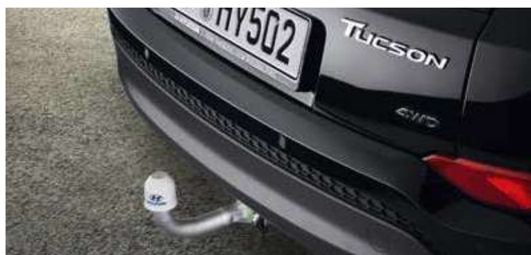
Vlečna kljuka / vertikalno snemljiva / ko ni v uporabi, ni vidna D7281ADE10
