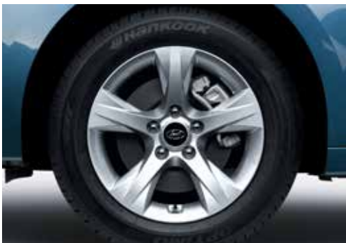
16 palčna aluminijasta platišča 7.0 x 16, 205/60 R16 3ZF40AC150 (za TPMS*)
