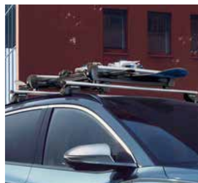
Nosilec za smuči ali snežne deske 600 za 6 parov smuči ali 4 snežne deske 99701ADE00
