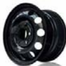
14-palčno jekleno platišče 5.5Jx14, 175/65 R14
