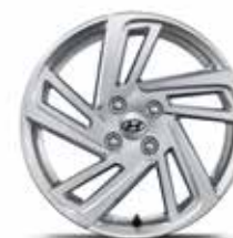
16-palčna aluminijasta platišča / srebrna 6.5Jx16, 195/45 R16 Okrasni pokrovček in matice niso vključeni.
